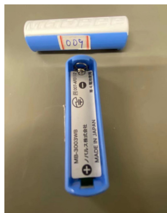
図2: 乾電池型 IoT デバイス MaBeee
